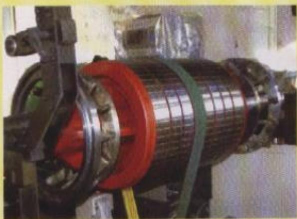
电机转子动平衡设备
